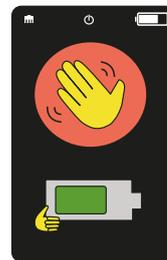
Das Herunterfahren des Systems wird 2 Sekunden lang angezeigt. Dabei wird auch der Akkuladezustand angezeigt. Nach weiteren 2 Sekunden wird das Display schwarz. Wenn das Cray X ausgeschaltet ist, erlischt die Ein-/Aus-Taste.
